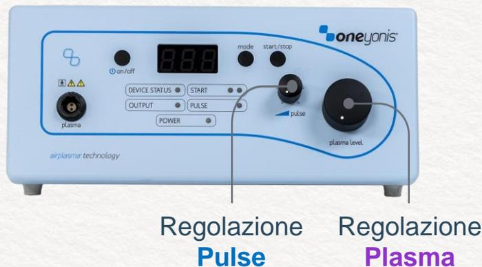
**Plasma** e **Pulse** regolano in maniera intuitiva il flusso e l'azione di **airplasma®** tramite due manopole circolari di diametro diverso (e quindi facilmente riconoscibili per la loro diversa percezione tattile). La regolazione rimane agevole anche indossando i guanti
